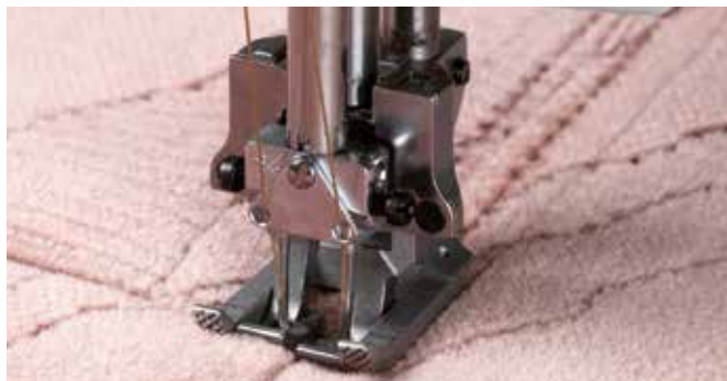
Kompenzační patka pro rozpíchy 6, 8, 10 a 12 mm. Compensating presser foot for needle gauge 6, 8, 10 and 12 mm. Компензационная лапка для распирания 6, 8, 10 и 12 мм.
