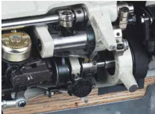
Olejové čerpadlo zajišťuje rovnoramennou dodávku oleje do všech mazacích míst.
