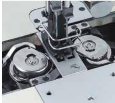
Při šití silnými nitěmi zajišťují velkoprůměrové chapače dostatečnou zásobu spodních nití. Automatický odstříh zvyšuje produktivitu výroby.
