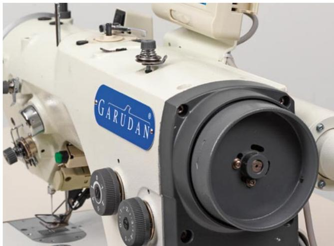
Stroj je vybaven zabudovaným minimotorem v hlavě šicího stroje. Toto provedení zjednodušuje montáž stroje, odstraňuje nutnost kontroly a napínání klínového řemene, snižuje hlučnost a vibrace stroje. Stroj má rychlejší náběh, a tím zvyšuje produktivitu výroby.
