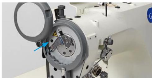
Mechanism nastavení vůle mezi patkou a stehovou deskou se ovládá jednoduše přístupným šroubem. Správné nastavení zamezuje „řasení a brždění“ šitého materiálu.
