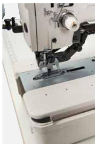
Ke stroji existují 3 velikosti přítlačných rámečků, které se dodávají jako šicí sada: SGBH0001 (pro nože 6,4 až 19,1 mm) SGBH0002 (pro nože 6,4 až 25,4 mm) SGBH0003 (pro nože 6,4 až 31,8 mm)
