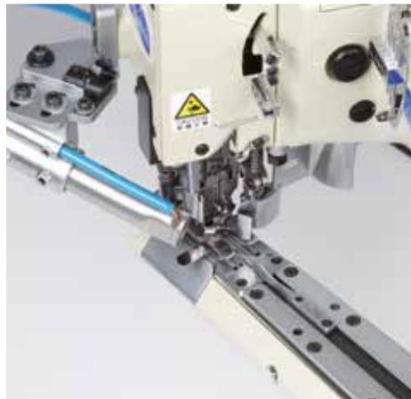
Stroj je standardně vybaven zařízením pro odsávání ořezávaného materiálu. Tento je v průběhu šití odsáván a sbírán do zásobníku. Toto vybavení udržuje pracovní plochu v čistotě a zamezuje náhodnému zašití oříznutého materiálu.
